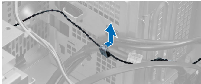
5. לחץ בעדינות על הלשוניות שבשני הצדדים כדי לשחרר ולהסיר את החיישן התרמי מהמארז.
